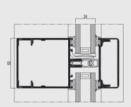
CW60 est un système à hautes performances de largeur vue de 60mm pour façades et toitures. Grâce à sa feuillure de 25mm ce système est convient spécialement aux constructions comportant de grands et lourds volumes de vitrage.
